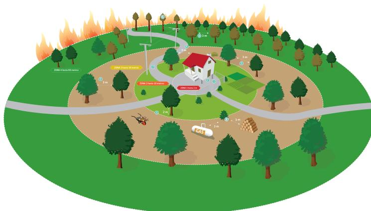
Figura 30: Esquema de protección para casas aisladas.
